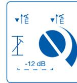
Die Multischalter verfügen über Synchronregler, um die unterschiedlichen Pegel der verschiedenen Bänder (Low-Band; High-Band) anzugleichen. Pro Band steht ein Regler zur Verfügung. Der Eingangspegel kann um 0...12 dB reduziert werden. Die ZF-Signale sind den Multischaltern entsprechend der Beschriftung zuzuführen, damit die logische Zuordnung der ZF-Ebenen gemäß den Umschaltkriterien stimmt.
